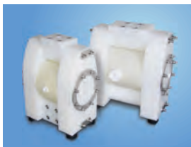
AH 系列機型 (高壓2:1型) 口徑尺寸：1/2", 1", 1-1/2" 主體材質：PE 膜片材質：PTFE/EPDM-compound 流 量：4 ~ 20 m 3 /h 最大吐出壓力：15 bar
