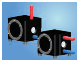
CXM 系列機型 (導電型) 口徑尺寸：3/8", 1/2", 3/4", 1", 1-1/4", 1-1/2" 主體材質：PE-conductive 膜片材質：PTFE/EPDM-compound 流 量：10 ~ 130 l/min 最大吐出壓力：7 bar
