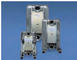
AD 系列機型 (金屬型) 口徑尺寸：3/4", 1-1/4", 2" 主體材質：SUS316 膜片材質：EPDM, PTFE/EPDM 流 量：4.5 ~ 24 m 3 /h 最大吐出壓力：7 bar
