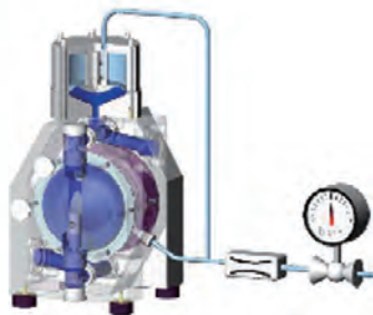
AH 系列機型 (高壓2:1型) 口徑尺寸：1/2", 1", 1-1/2" 主體材質：PE 膜片材質：PTFE/EPDM-compound 流 量：4 ~ 20 m 3 /h 最大吐出壓力：15 bar
