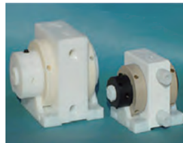
Futur 系列機型 (高純淨無金屬型) 口徑尺寸：3/8", 1/2", 1", 1-1/4", 1-1/2" 主體材質：UPPE, PTFE-TFM, SS316L 膜片材質：PTFE 流 量：10 ~ 200 l/min 最大吐出壓力：6 bar
