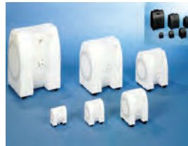
E 系列 (A系列進階機型) 口徑尺寸：1/4", 3/8", 1/2", 1", 1-1/2", 2" 主體材質：PTFE, PE, PTFE-conductive, PE-conductive 膜片材質：EPDM, PTFE/EPDM-composite 流 量：0.6~48m 3 /h 最大吐出壓力：7bar
